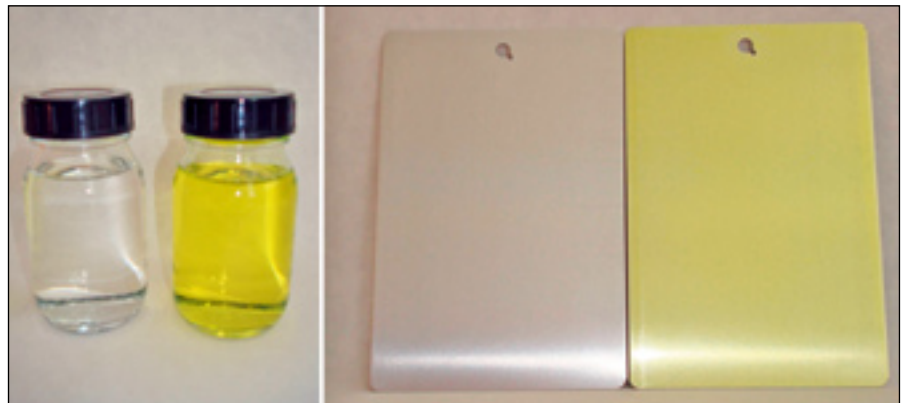
Abb. 1: Sol/Gel-Lösungen (a) und Sol/Gel-Schichten auf Aluminium (b): jeweils ohne (links) und mit Fluoreszenz-Farbstoff „S 0679“ (rechts)
