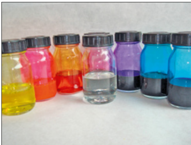
Abb. 3: Farbige Sol/Gel-Lösungen, in der Mitte Sol ohne Farbstoff
