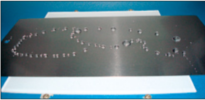
Abb. 4: Anti-adhäsive Sol/Gel-Beschichtung auf Aluminium unter Tageslicht
