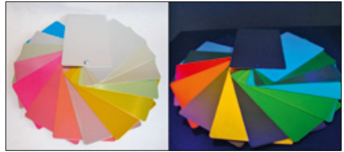
Abb. 3: Farbige Sol/Gel-Schichten auf Aluminium, links: unter Tageslicht, rechts: unter Schwarzlicht
