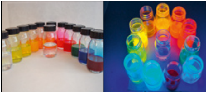
Abb. 2: Farbige Sol/Gel-Lösungen, links: unter Tageslicht, rechts: unter Schwarzlicht
